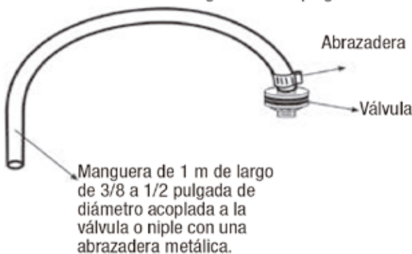
Válvula metálica de 7 cm de largo 3/8 a 1/2 pulgada de diámetro
